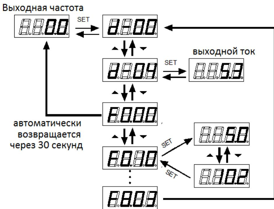
После установки параметра возвращаемся в мониторинг частоты:
