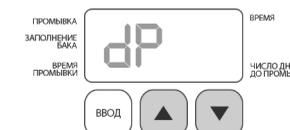
Если выбрана немедленная регенерация, после входного сигнала в течение 2 минут начнется немедленная регенерация. Если выбрана отложенная регенерация, клапан начнет регенерацию в установленное для регенерации время, заданное в Шаге 1 и 2 настроек пользователя.
