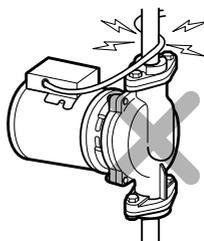
3. Не допускать контакта силового кабеля с горячими патрубками.
