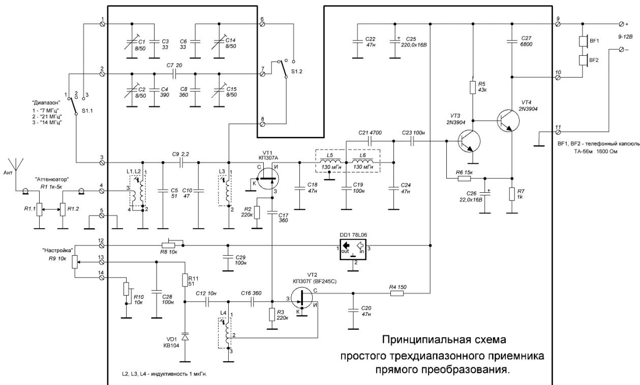
Разница между схемами в наличии дополнительного стабилизатора 78L06, вариакапа, подстроековых резисторов и других элементов обвязки вокруг вариакапа. Перед монтажом заранее определитесь, какую схему Вы будете собирать.
