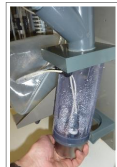
Рис. 16. Снятие бака распылителя
