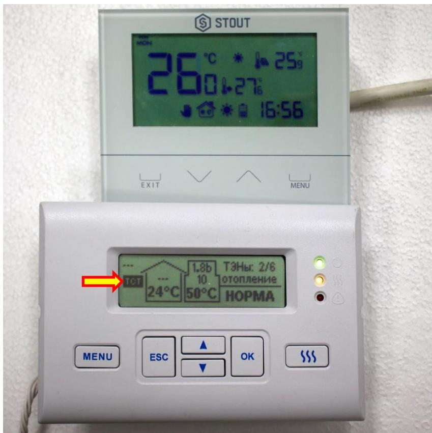
В условиях, когда термостат отключает котел, на экране будет отображаться индикатор (ТСТ) без цветового заполнения.
