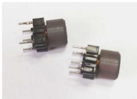
**Катушки полосового фильтра ФСС L5, L6, L7** имеют по 26 витков, а L8 – 4 витка поверх L7 проводом 0,16 и помещены в малогабаритные карбонильные чашки типа СБ-12. Частоты настроек контуров: L5,C5 - 6,25 МГц; L6,C9 - 6,0 МГц; L7,C13 - 6,5 МГц; При необходимости можно немного скорректировать конденсаторы С5, С9, С13. Чашки СБ12 между собой следует приклеить спиртовым kleem (например, БФ-2). Внимание! Не использовать ацетоносодержащие клей – он может испортить кольца.
