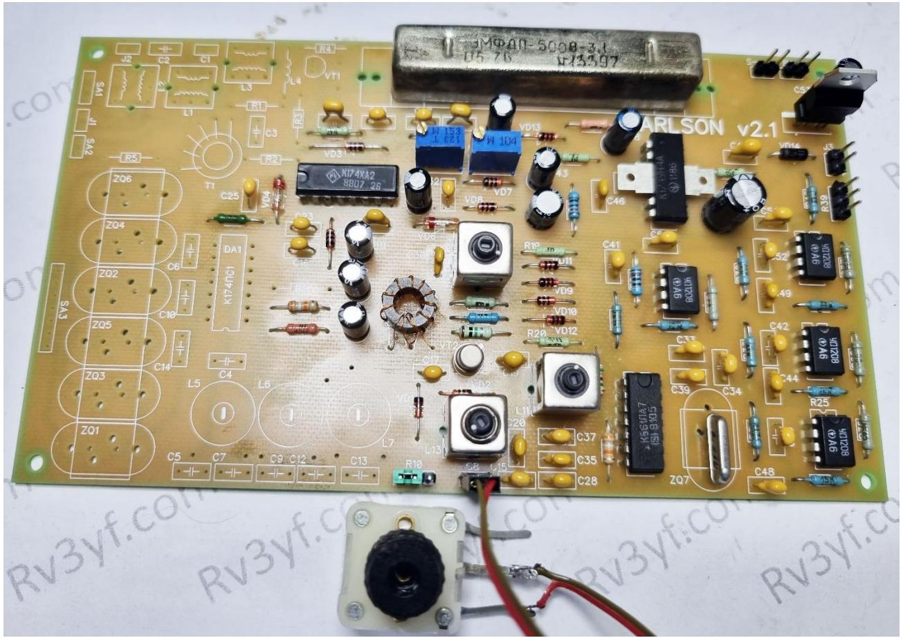
7. Далее удобнее всего собрать схему буфера для частотомера на транзисторе VT1. Собираем, проверяем на выходе J1 уже настроенную частоту ГПД.
