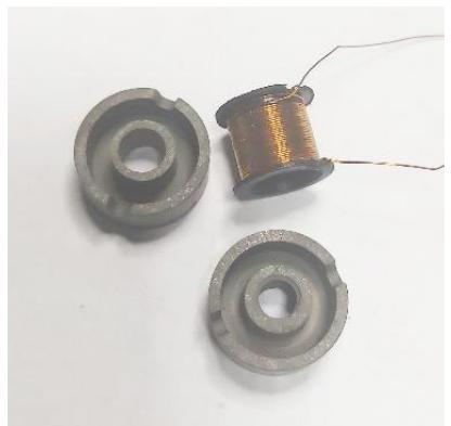
**Катушки входного селектора L1, L2, L3** наматываются на каркасах диаметром 5 мм, проводом ПЭВ-2 0,16мм с обмотками: L1 – 12 витков (индуктивность ~0.5мкГн), намотка виток к витку, L2 –16 витков (индуктивность ~0.9 мкГн), намотка виток к витку, L3 – на многосекционном каркасе, 40 витков (по 8 витков в каждой секции) с отводом от 10 витка снизу – «от земли» (индуктивность ~8мкГн).
