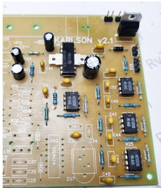
сигнал 1000-2500 Герц амплитудой 30-50мВ на вход фильтра (конденсатор C41). Снимаем показания на выходе фильтра – на резисторе R39. Уровень сигнала должен быть не ниже входного. Если есть возможность посмотреть сигнал на осциллографе, то дополнительно убеждаемся в его «чистом синусе».
