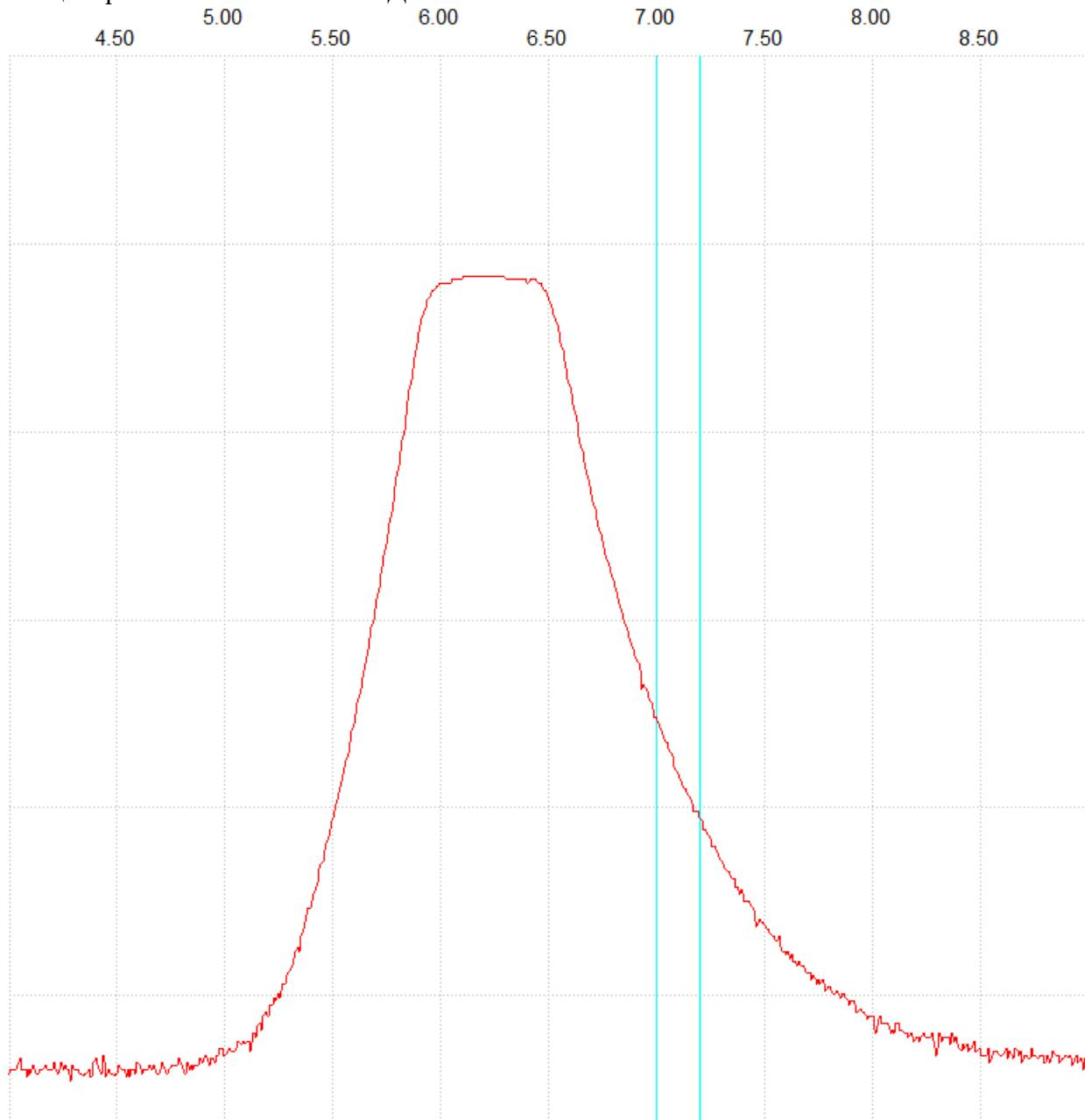
11. Настройку входных фильтров также рекомендуется проводить с помощью прибора NWT или с помощью генератора и ВЧ вольтметра. Выходной щуп подаем на антенный разъем, а измерительный на выходе после контура L3. Также необходимо подключить конденсатор С1. Настройку начинают с диапазонов 3,5 и 7 Мгц., далее переходят к настройке 14 и 21 МГц, подключая катушку L2 с помощью переключателя SA1 (для настройки можно использовать
