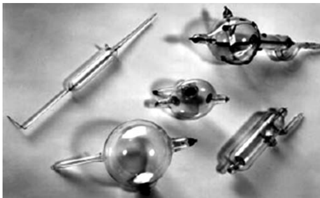
Рис. 1.3. Виды трубок, которые использовал В.К. Рентген в 1895–1896 гг. для получения X-лучей
