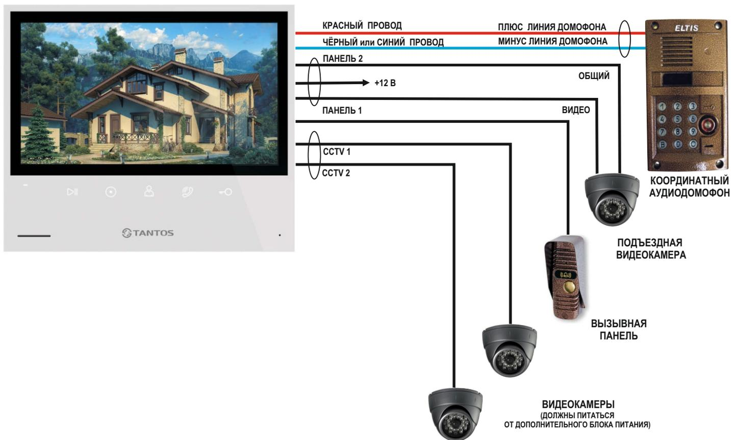
**НА РАЗЪЕМ ПАНЕЛЬ 2 ПОДКЛЮЧАЕТСЯ ТОЛЬКО ПОДЪЕЗДНАЯ ВИДЕОКАМЕРА.
