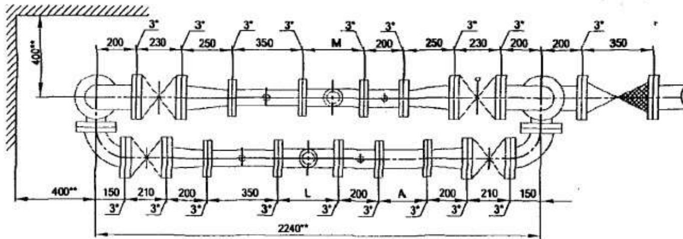
Установка счетчика  $d_u=65$  мм на хозяйственно-питьевой линии и счетчика  $d_u=65$  мм на пожарно-резервной линии в водомерном узле на вводе диаметром 100 мм.
