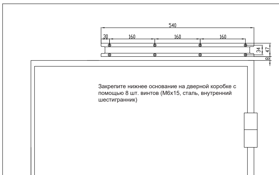
Монтаж с правой стороны
