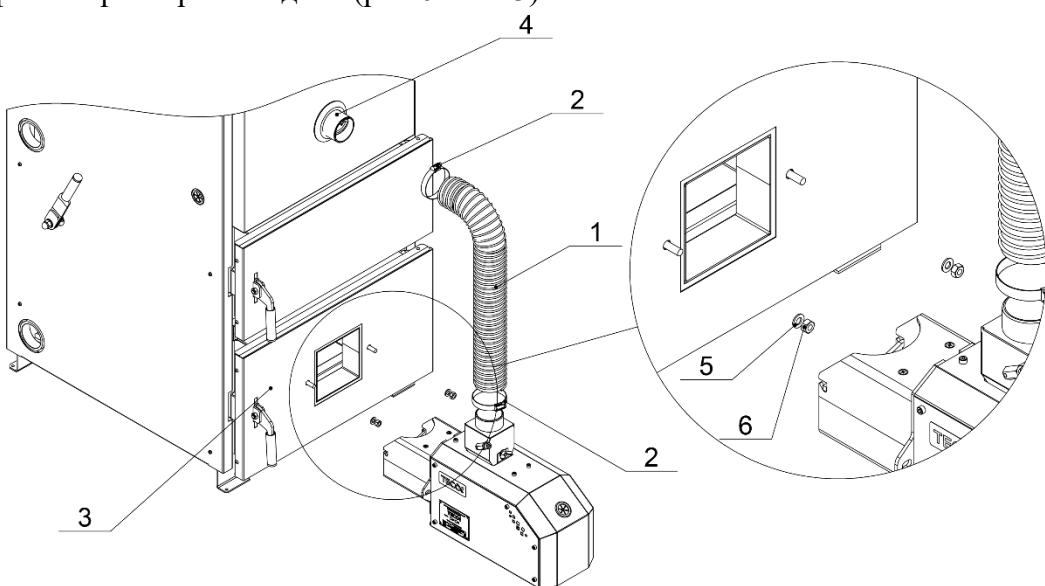
**Рис. 7 Установка пеллетной горелки ТЕКО PELLET**
