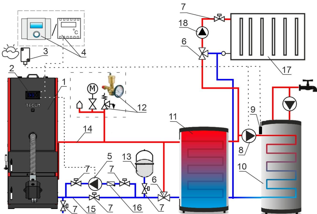
**Рис. 14 Гидравлическая схема подключения<sup>1</sup>**
