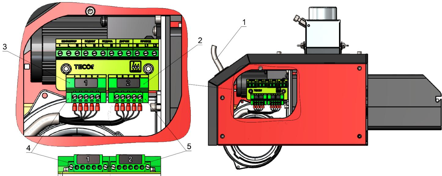
**Рис. 9 Подключение разъемов кабеля управления пеллетной горелки ТЕСО PELLET**
