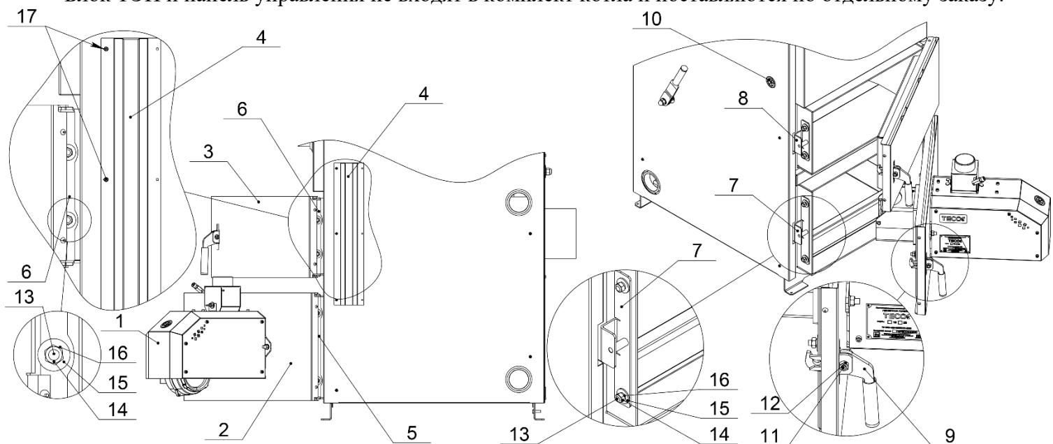
**Рис. 4 Изменение направления открытия дверец котла**
