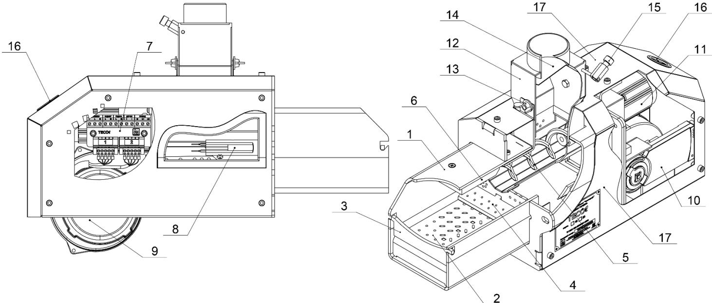
**Рис. 6 Устройство пеллетной горелки котла ТЕКО PELLET**
