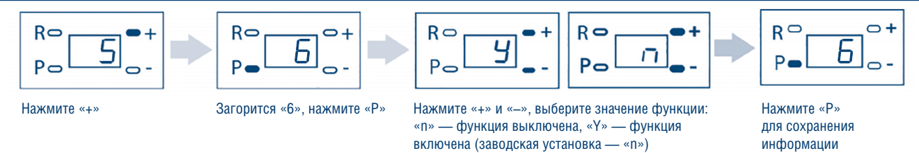
Рис. 6.3.6. Реверс каретки в закрытом положении ворот
