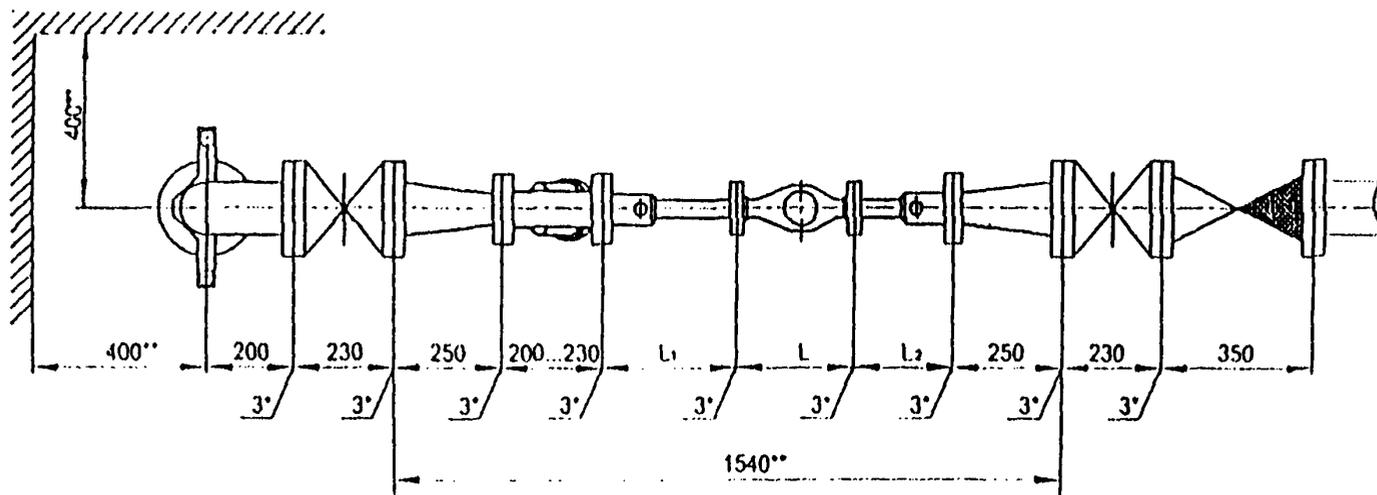
Установка счетчиков  $d_u=20...50$  мм в водомерном узле
