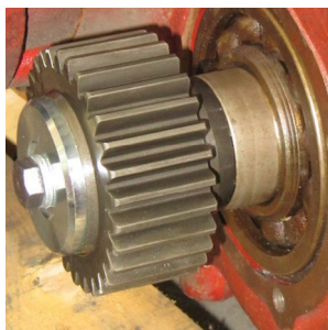
Montaggio ultimato Mounting complete
