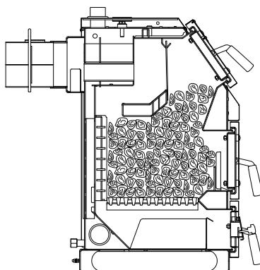
**Рис.11 Заполнение котла топливом для номинального режима**
