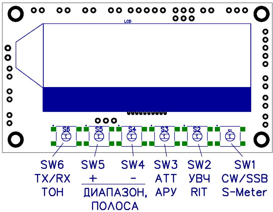
прием/передача с синтезатора. Если необходимо преобразовать +3.3В до 12В и выше, можно воспользоваться схемой, аналогичной для переключения режимов ТОН, CW, PRE, ATT и АРУ. Также в синтезаторе реализован вход для получения сигнала о переходе в режим передачи от внешнего источника, (например, переключение происходит педалью или тангентой). Для переключения в режим передачи на вход +12TX нужно подать +12В. Это удобно сделать от основной платы.
