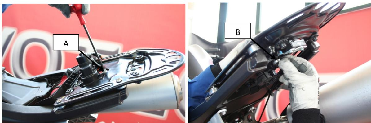
4) Montare il portatarga Evotech sulla staffa ESTR-0805-S2 utilizzando i due gruppi vite + rondelle a tazza + dado M8 INOX forniti nel KIT. Montare il gruppo appena assemblato sulla placca ESTR-0806-S1, utilizzando i 3 bulloni M6 (B) in acciaio INOX forniti nel KIT Evotech. Nel caso si voglia montare una luce ricavata dal pieno EVOTECH, fissare ora il dispositivo e far passare il cavo elettrico nelle apposte fessure.
