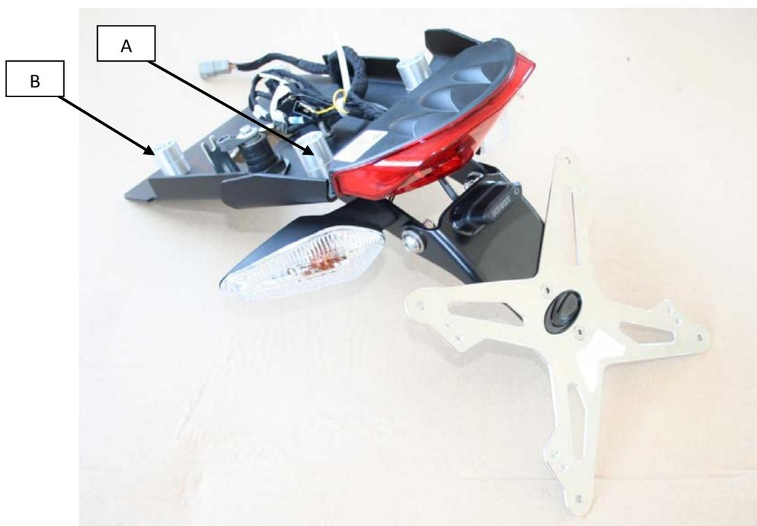
6) Montare gli indicatori di direzione nelle cave presenti sulla staffa ESTR-0805-S2. Assicurarsi che il fascio di cavi dei vari dispositivi di illuminazione passi attraverso una delle fessure predisposte (si consiglia di utilizzare il foro anteriore per passaggio cavi, per rendere più pulito il layout). Collegare ai vari connettori la prolunga smontata nel punto 1. Per la luce targa è necessario effettuare un collegamento con dei connettori fastom tradizionali (non presenti nel KIT).
