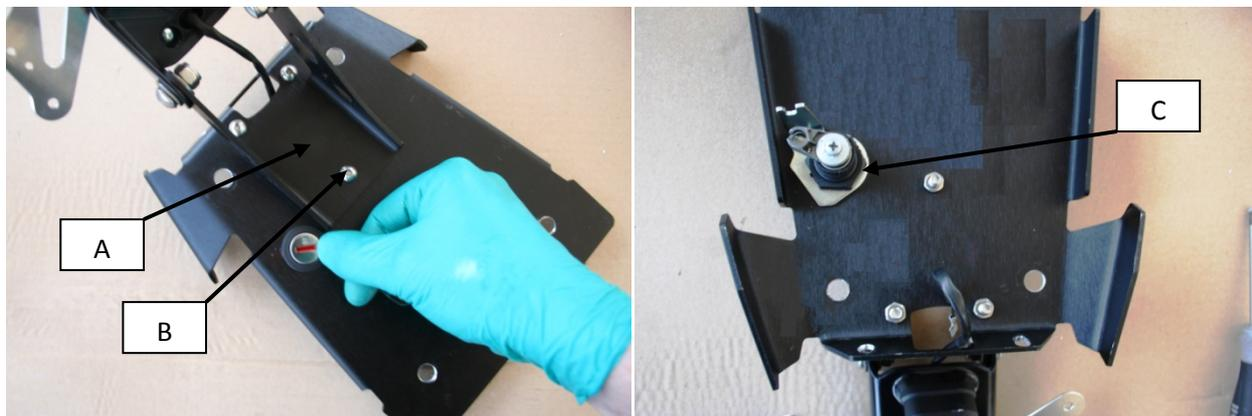
5) Fissare il faro posteriore LED di serie DUCATI MONSTER 1100 sul lembo presente sul particolare ESTR-0806-S1, utilizzando le viti autofilettanti di serie. Regolare la posizione del dispositivo di illuminazione in modo da conferire successivamente una posizione ottimale rispetto al telaio posteriore.
