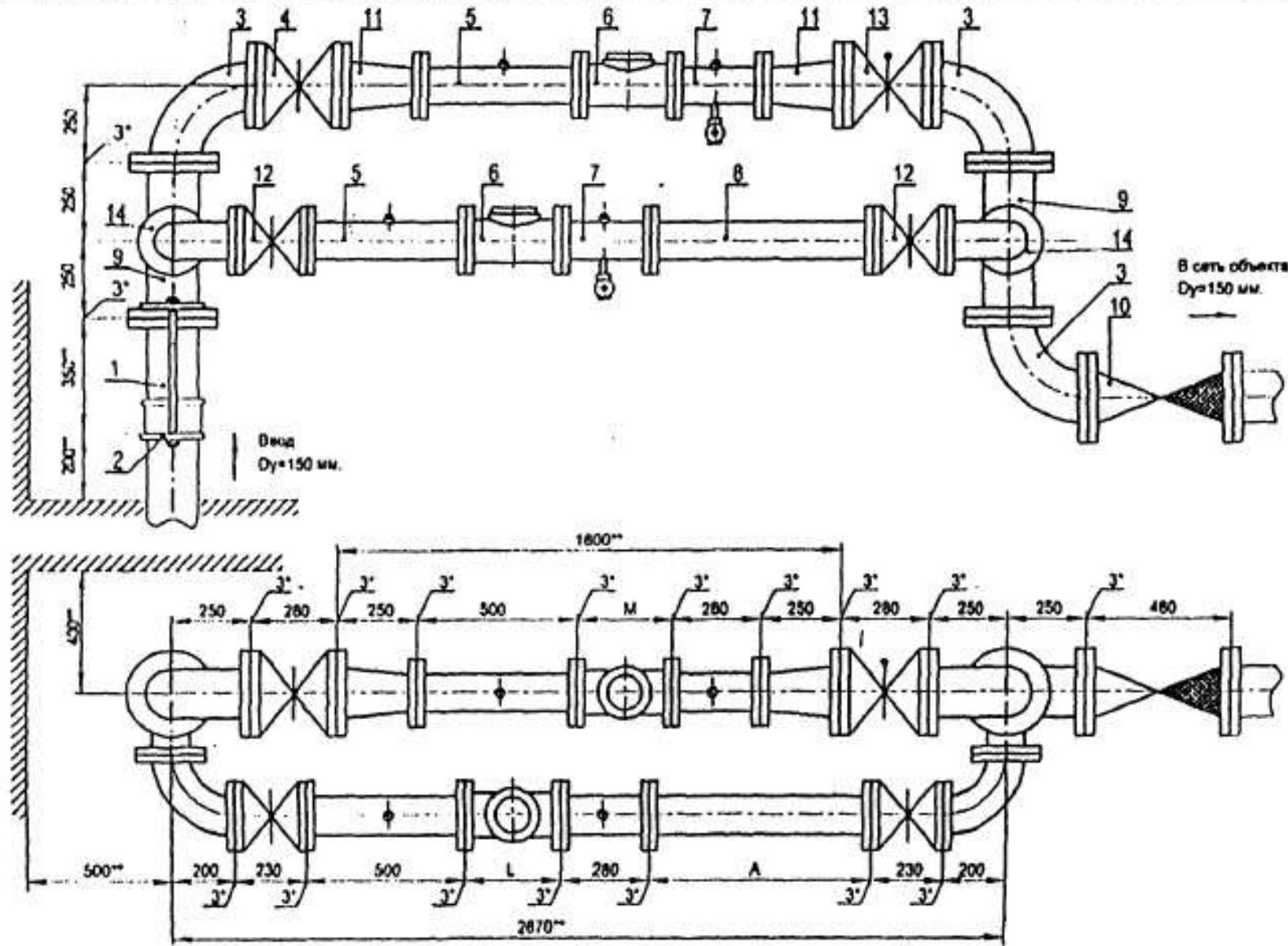
Установка счетчика ду=100 мм на хозяйственно-питьевой линии и счетчика ду=100 мм на пожарно-резервной линии в водометном узле на воде диаметром 150 мм.
