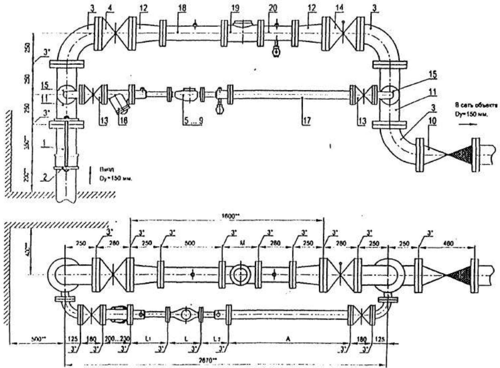
Установка счетчиков фу-20...50 мм на хозяйственно-питьевой линии и счетчика фу=100 мм на пожарно-резервной линии в водоподъемном узле на пода диаметром 150 мм.
