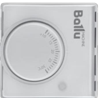
Термостат механический ВМТ-1 применяется для регулирования поддерживаемой в помещении температуры. В качестве чувствительного элемента используется сиффон, заполненный газом. Обычно применяется в коммерческих помещениях, в домашних системах отопления и кондиционирования воздуха совместно с климатической техникой. Данный термостат не устанавливается в помещениях с повышенной влажностью и в агрессивных средах (Класс защиты IP40).
