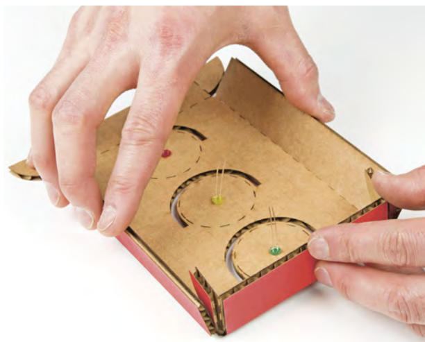
Рис. 2.20. Сгибание сторон корпуса светофора по надрезанным линиям
