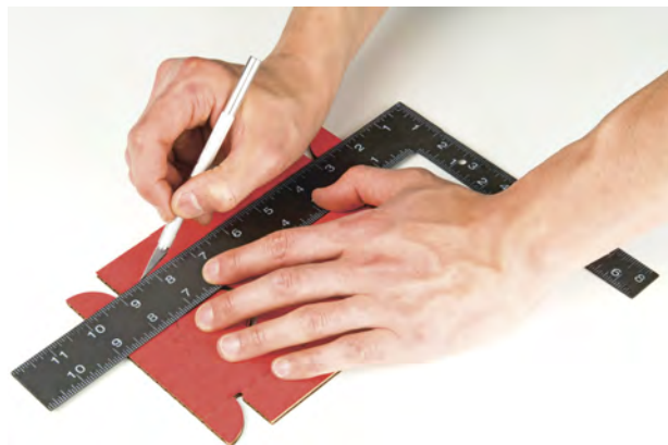
Рис. 2.16. Надрезание линий изгиба корпуса с помощью макетного ножа и металлической линейки
