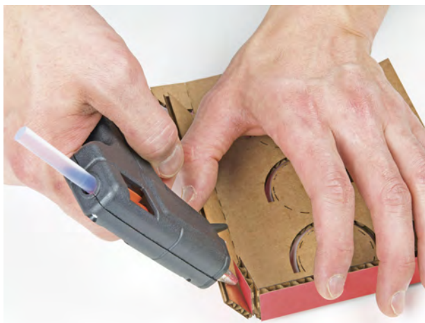
Рис. 2.21. Гибка и склейка картонного корпуса модели светофора
