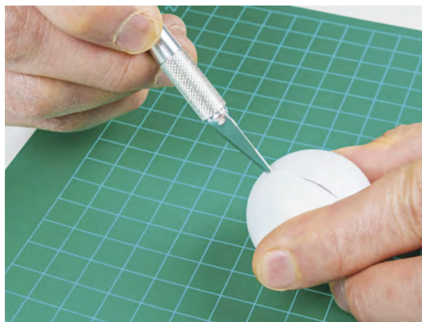
Рис. 2.22. Безопасный способ разрезки мячика для настольного тенниса
