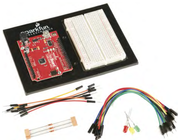
Рис. 2.2. Электронные компоненты для проекта «Светофор»
