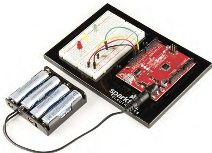
Рис. 2.13. Делаем проект «Светофор» автономным, используя держатель батареек в качестве источника питания
