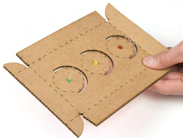
Рис. 2.18. Светодиоды, вставленные в заготовку корпуса модели светофора
