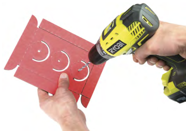
Рис. 2.17. Сверление отверстий под светодиоды
