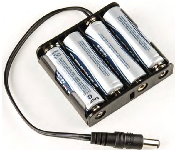
Рис. 2.12. Держатель на 4 батарейки AA с цилиндрическим разъемом
