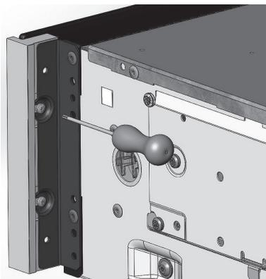
Переднюю панель прибора можно сместить на несколько миллиметров, чтобы сравнять ее с другими кухонными аппаратами. Для этого используйте шестигранный ключ и паз внизу прибора.
