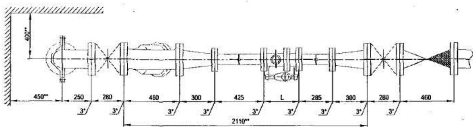
Установка комбинированного счетчика с диаметром основного канала Dу=80 мм
