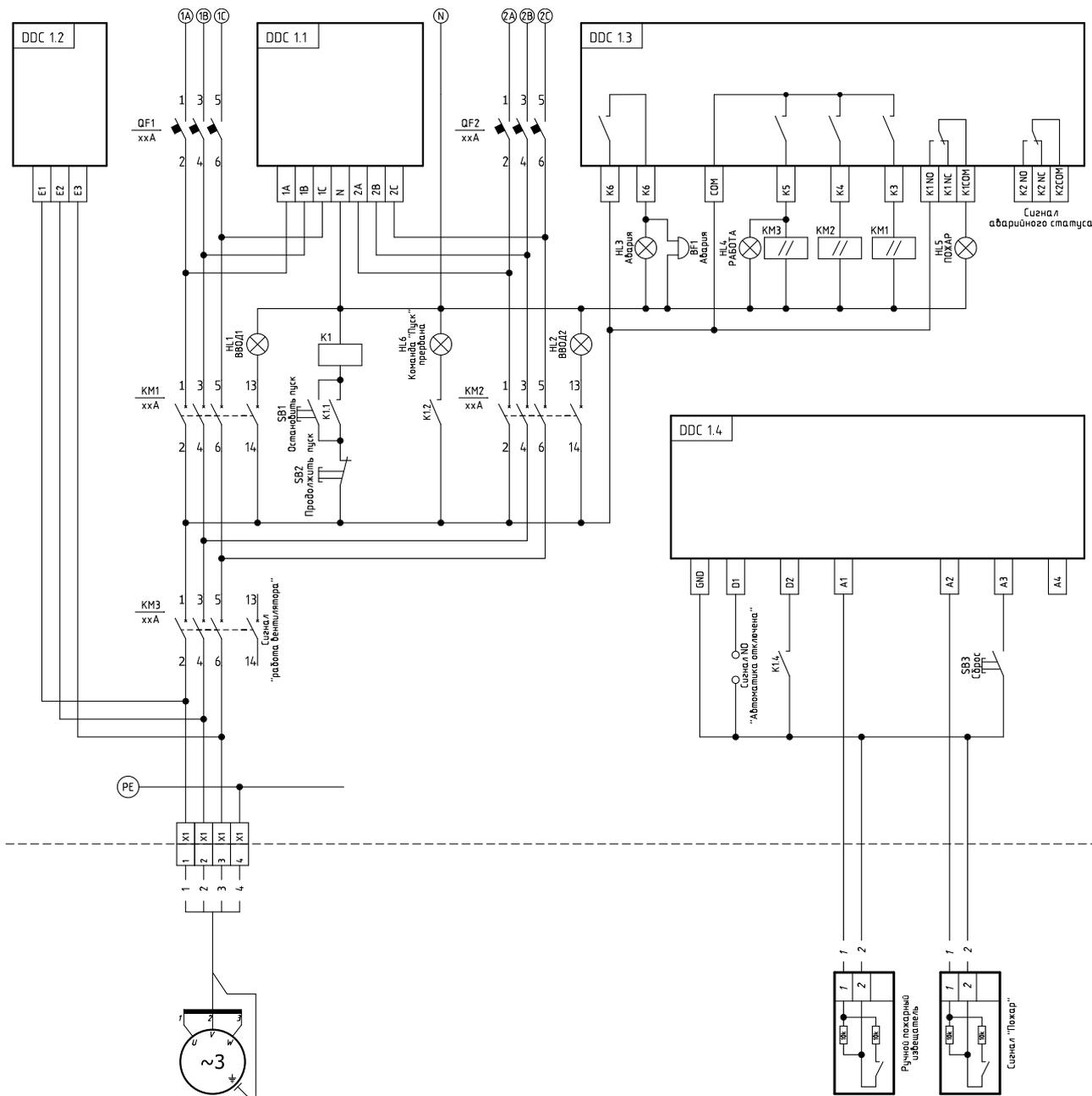
Реализация АВР, управления вентилятором с контролем целостности линии питания вентилятора, линий ручного извещателя и пожарной сигнализации.
