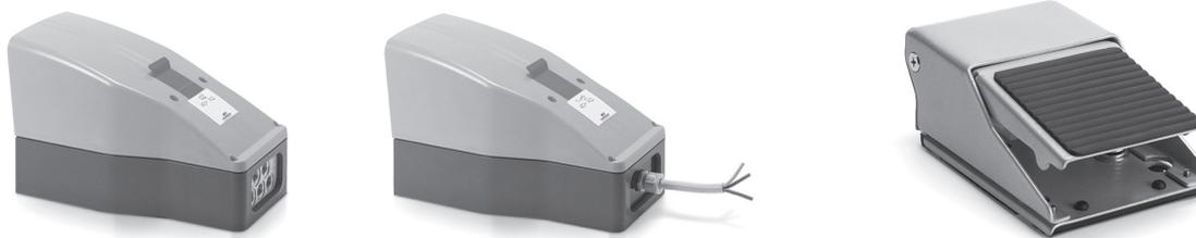
Доступны для заказа пневматические и электрические педали. Пневмопедаль оснащена 5/2 лин./поз. распределителем с присоединительными отверстиями G1/4, которые располагаются в передней части педали, что позволяет легко и удобно монтировать фитинги и глушители. Для получения функции 3/2 лин./поз. необходимо заглушить одно выходное отверстие распределителя.
