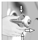
Осторожно выверните и выньте предохранительные транспортировочные болты с пластиковыми и резиновыми втулками.
