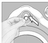
Закройте отверстия на задней стенке пластиковыми заглушками, которые находятся в пакете с инструкцией по эксплуатации. (Р)
