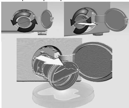
4 Очистите внутреннюю часть фильтра и пространство вокруг крыльчатки насоса от мусора и волокон.
