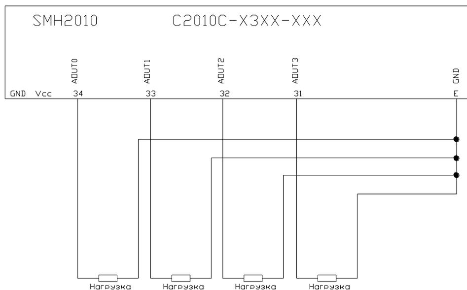
**Модификация C2010C-X2XX-001-X** имеет 2 аналоговых выхода: AOUT0 и AOUT1, которые размещаются на клеммах 33 и 34, вместо дискретных входов DIN11 и DIN10.
