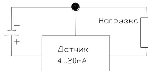
Для питания датчика необходимо использовать источник достаточной мощности. Стандартный модуль RPS2014 не предназначен для питания внешних, по отношению к SMH2010, нагрузок. При этом необходимо объединить "GND" питания SMH2010 и "аналоговую землю".
