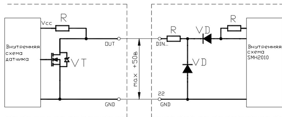
В этом случае, для питания схемы можно использовать внешний источник постоянного тока, напряжением до 50 в.
