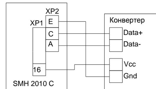
Схема соединений между SMH2010 и конвертером с использованием источника релейного модуля RPS 2014B.
