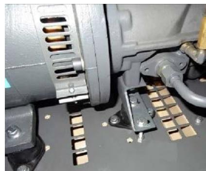
Рис. 7. Шокозащитный крепеж
