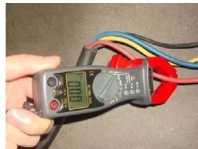
Рис. 15. Клещеобразный амперметр
