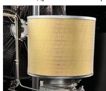
Рис. 11. Воздушный фильтроэлемент
