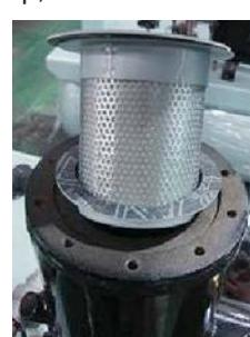
Рис. 12. Масляный сепаратор
