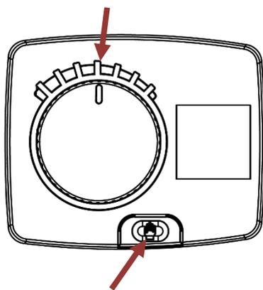
Переключите режим управления приводом с автоматического на ручной, нажав на кнопку.
