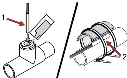
Датчик температуры поместите в погружную гильзу (1) или закрепите с помощью хомута на трубе (2).
