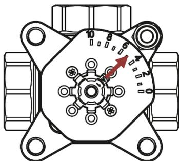
Перед установкой привода поверните шток клапана и рукоятку привода в положение 45° между выходами клапана подающей и обратной линии, как показано на рисунке.
