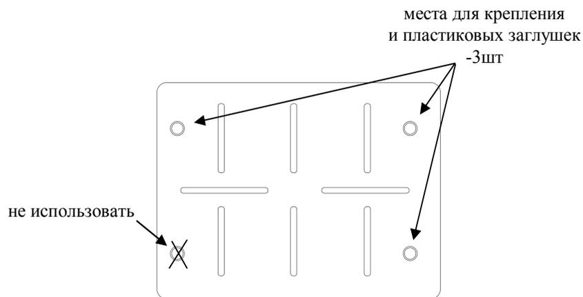
Рис. 3 Крепление корпуса прибора на стене
