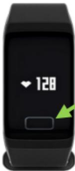
Чтобы произвести измерение кислорода, пульса или давления, пролистайте до нужного пункта и остановитесь на 30 секунд. По окончании замеров данные появятся на экране.
