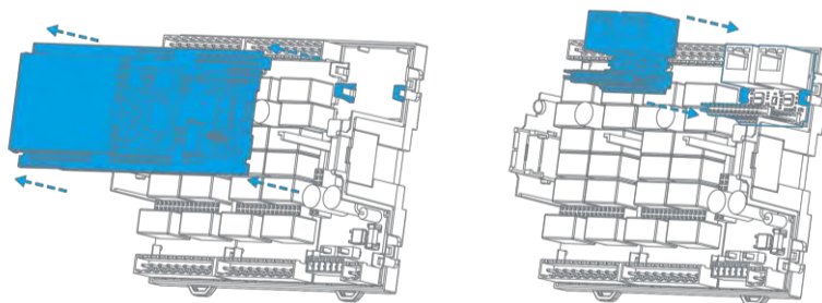
Рис. 63 – Снятие процессорной платы и установка платы сетевого модуля
