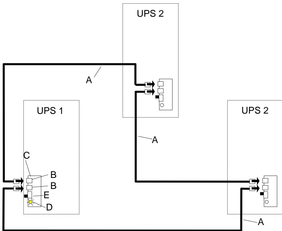
Для добавления других ИБП при параллельном подключении необходимо добавить по одному кабелю “ПАРАЛЛЕЛЬНЫЙ КАБЕЛЬ ИБП” на каждый вновь подключаемый ИБП *MASTER HP*.
