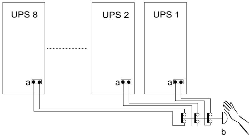
а - Клеммник ЕРО, имеющийся на всех ИБП
