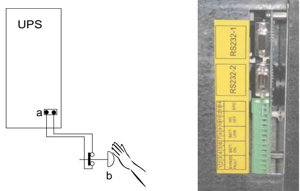
На ИБП следует удалить перемычку, имеющуюся на клеммах ЕРО (страница 35), а вместо нее должны быть подключены провода, идущие от контакта кнопки.
