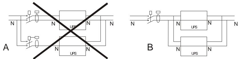
Во избежание ложных срабатываний, в версиях с несколькими аппаратами, подключенными параллельно, на входе всей системы должен быть установлен всего один дифференциальный выключатель, как показано на рисунке В.
