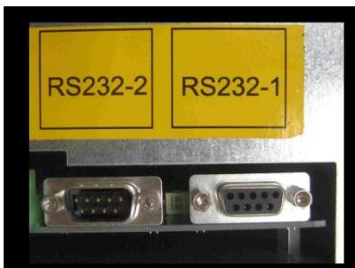
Для подключения RS232 имеются 2 разъема DB9. Протокол передачи, предварительно установленный в заводских условиях, - следующий:
