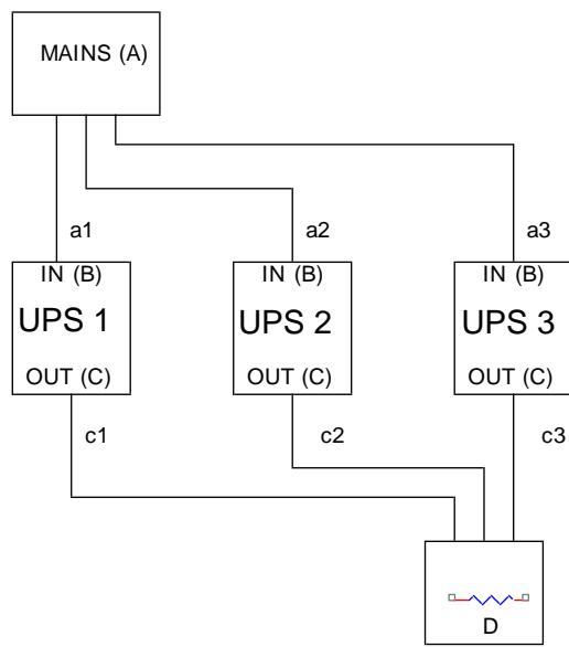
Здесь показан пример параллельного подключения трех ИБП.
