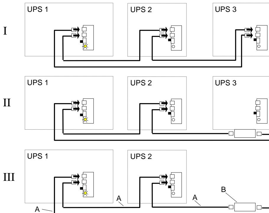
А) кабель параллельного подключения ИБП типа RJ45
