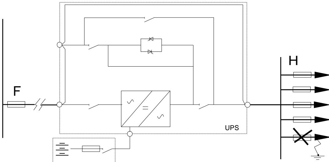
При выборе необходимых устройств защиты, устанавливаемых на выходе ИБП, следует учитывать два режима работы: питание от сети и питание от батареи.
