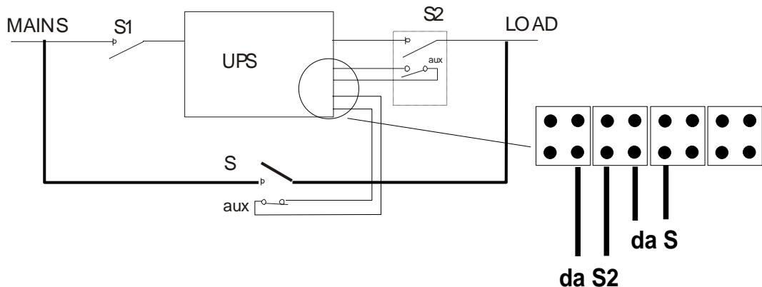
S2 – дополнительный разъединитель на выходе, S – дополнительный внешний разъединитель байпаса обслуживания.
