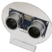
Теперь можно установить держатель ультразвукового датчика на качалку и сам датчик.
