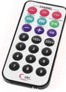
При включении Smart Car робот находится в режиме управления с пульта. Для того, чтобы управлять роботом с ИК-пульта, необходимо в скетче настроить коды, присваиваемые кнопкам пульта при их нажатии.
