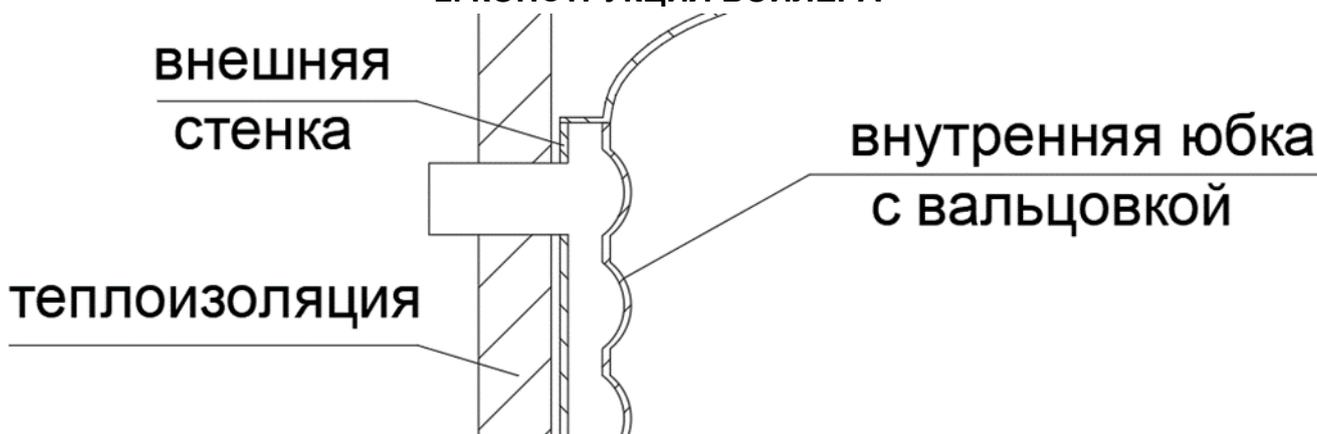
2.1. Бойлер FB INOX Premium сконструирован по схеме внутренний бак бойлера (контур горячего водяного снабжения (далее ГВС) с водяной юбкой (контур обогрева бойлера через систему отопления (далее СО)). Для повышения производительности внутри водяной юбки предусмотрены направляющие потока воды. Для увеличения прочности, внутренние стенки имеют вальцовку.
