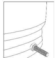
5.4. Водонагреватель необходимо подключить непосредственно к водопроводной сети с давлением не более 6 бар. Минимальное давление не должно быть меньше 2 бар. Труба подачи холодной воды должно присоединяться через предохранительный клапан на 6 бар, расширительный бак системы ГВС не менее 10 литров (10% от объема контура ГВС).
