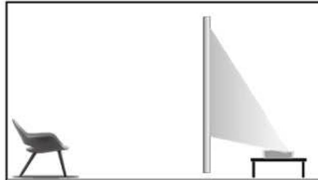
Рис. 10 Проектор позади экрана
