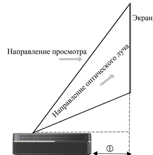
Рис.13 Расстояние установки
