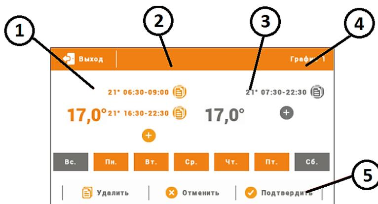
Экран редактирования временных пределов позволяет настроить заданную температуру и временные рамки с точностью до 15 минут.
