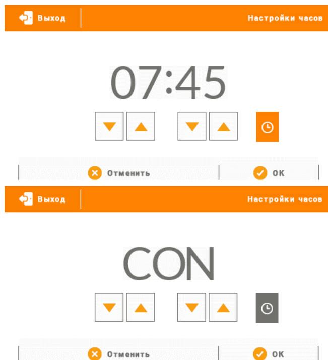
Нажимая на область часов можно установить постоянная заданная температура (constants) — на главном экране в области обозначенной номером 6 отобразится надпись ((CON) область обозначена номером 2 в разделе 5.6. «Обслуживание зон» – смотреть ниже).
