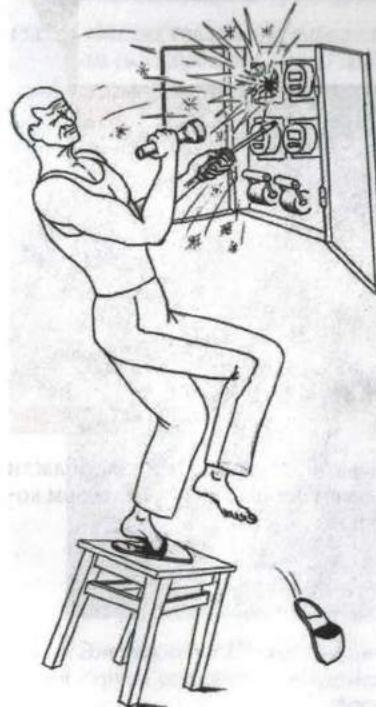
Рис. 8. Вариант получения ожога вспышкой вольтовой дуги
