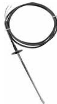
Канальный датчик температуры ETF1144/99-NTC предназначен для использования в воздушных потоках, для измерения температуры газообразных сред – например, в каналах систем вентиляции и кондиционирования воздуха. Принцип измерения температуры основан на зависимости электрического сопротивления чувствительного элемента, находящегося в защитной трубке, от температуры.
