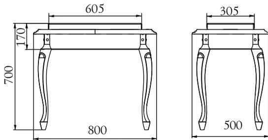
Рисунок 1. Габаритные размеры мангала в рабочем состоянии
