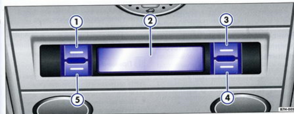
Илл. 123 Вырез в потолочной панели: органы управления дополнительного отопителя
