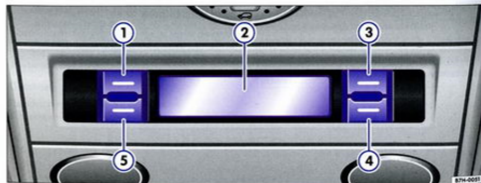
Илл. 124 Вырез в потолочной панели: органы управления дополнительного отопителя
