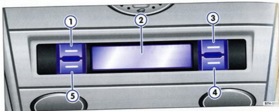
Илл. 122 Вырез в потолочной панели: органы управления дополнительного отопителя
