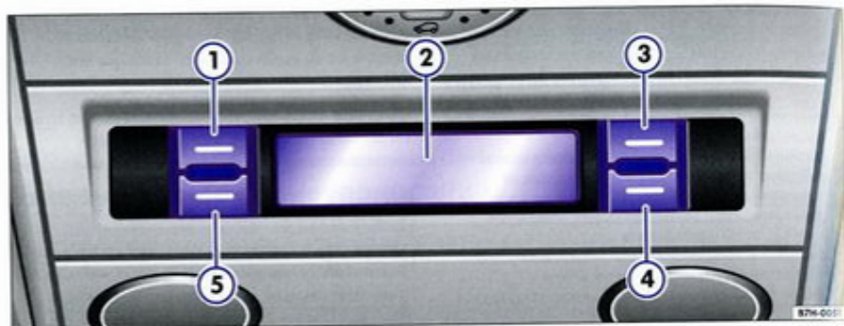
Илл. 126 Вырез в потолочной панели: органы управления дополнительного отопителя
