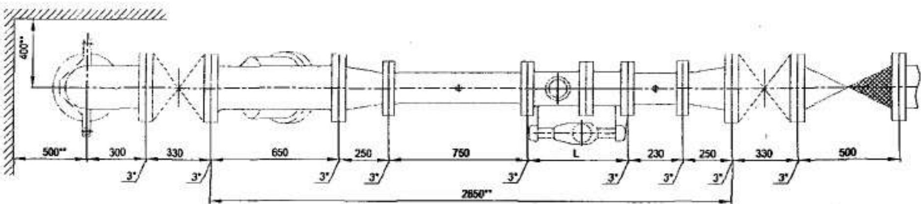
Установка комбинированного счетчика с диаметром основного канала ду=150 мм
