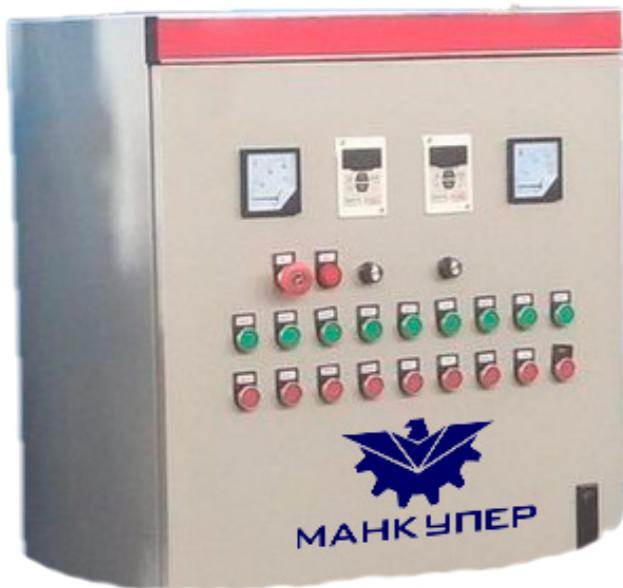
4. Панель управления выделенная на фотографии справа, управляет выдувом, а другая контролирует скорость вибрации. (рис.2)
