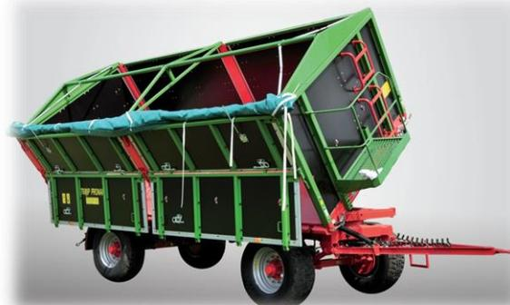
Кузов со специальной системой открытия бортов в виде распашных ворот с боковой стороны предоставляет возможность удобной загрузки и разгрузки. Борты прицепа PRONAR T680P изготовлены из водостойкой фанеры (легкий и предохраняющий от коррозии материал), ламинированные фольгой с окантовкой алюминиевым профилем и системой резиновых уплотнений позволяет перевозить материалы с низкой зернистостью н.п рапс.
