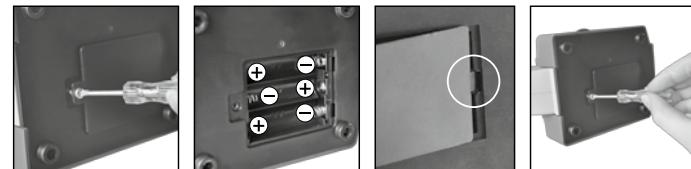
Om dingen te bekijken met het elektrische licht (6) heb je 3 AA batterijen van 1,5 V nodig, die in het batterijvak (8) in de voet van de microscoop (7) worden geplaatst. Het batterijvak dient met een kruiskopschroevendraaier geopend te worden. Let bij het plaatsen van de batterijen op de juiste polariteit (+/-). Het deksel van het batterijvak moet nu eerst rechts in de kleine opening gezet worden zodat het deksel precies past. Nu kun je het Schroefje aandraaien.
