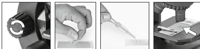
Para la observación normal, debes colocar el microscopio en un lugar donde haya claridad (junto una ventana o un flexo). Gira el tornillo micrométrico (2) hasta el tope superior y ajusta el revólver con objetivos (3) al aumento más pequeño.
