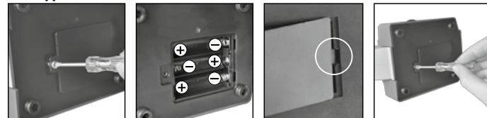
Для наблюдений с подсветкой (6) вставьте 3 батарейки AA 1,5 В в батарейный отсек (8), расположенный в основании микроскопа (7). Батарейный отсек можно открыть с помощью крестовой отвертки. При установке батареек соблюдайте полярность (обозначена знаками +/-). Затем поставьте крышку батарейного отсека на место, сначала ввинтив выступ крышки в маленький паз, и закрутите винт.
