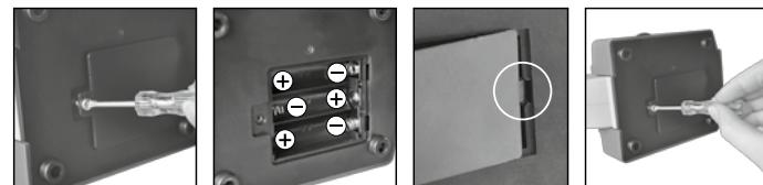
Pour l'observation de la source de lumière électronique (6), vous devez insérer trois piles AA 1.5V, dans le compartiment de la batterie (8) sur la base du microscope (7). Le compartiment des piles est ouvert à l'aide d'un tournevis cruciforme. Insérez les piles avec la polarité (+/- d'indication). Mettez le couvercle de la batterie en premier dans la petite ouverture pour que le couvercle s'adapte parfaitement. Maintenant, vous pouvez serrer la vis.
