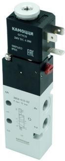
Распределители с электропневматическим управлением и пневмомеханическим возвратом (действует и пружина, и сжатый воздух – см. схему), используются для управления пневмоцилиндрами двустороннего действия.
