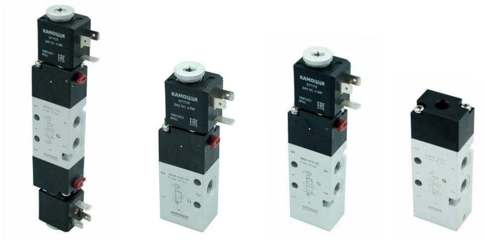
Распределители Серии 3N имеют присоединение G1/8, G1/4 и структуру 3/2 и 5/2. Поставляются в моностабильном и бистабильном исполнении. Распределители Серии 3N управляются электрическими катушками Серий U, A и G с размерами 22×22 мм.
