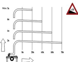
Протяженность горизонтального участка выводного трубопровода может максимально достигать 70 м, при длине вертикального участка до 2 м. Каждые последующие 2 м вертикального участка будут сокращать дальность перемещения откачиваемой сточной воды приблизительно на 10 м. Уклон горизонтального участка в сторону канализационного стояка должен быть не менее 3%.
