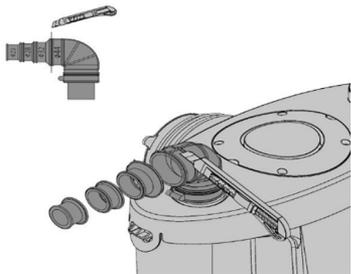
Для соединения насосной станции с напорным трубопроводом используйте угловой патрубок 1, повернув его в нужном направлении и закрепив хомутами 6. При монтаже напорной магистрали необходимо обеспечить выполнение следующих требований:
