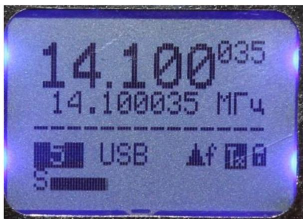
Синтезатор поддерживает отображение двух частот: текущая частота активного генератора отображается большими символами на экране, частота альтернативной частоты генератора указана ниже мелкими символами. Переключение между частотами происходит с помощью кнопки **SW4 “VFO A/B”**. Для того, чтобы уровнять частоты на обоих генераторах можно с помощью кнопки **SW8 “VFO A=B”**.
