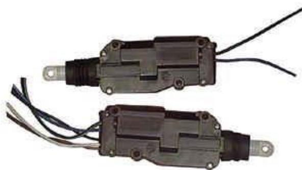
Рисунок 5.1 – Активатор (привод центрального замка автомобиля Saturn ms-200)
